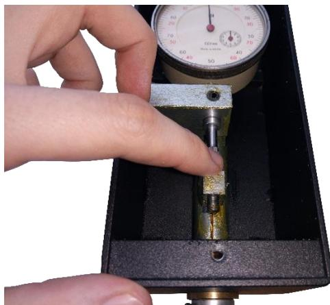
Рисунок 2.5 – Установка нуля индикатора
