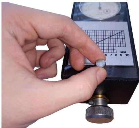
Рисунок 2.2 – Снятие защитной крышки
